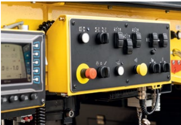
Equipamento de última geração para o segundo homem: painel de comando e tela complementam o posto de comando no solo.
