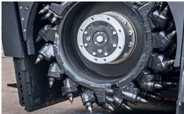
Proteção em carboneto contra desgaste e substituível para a caixa de fresagem e o cilindro de fresagem.
