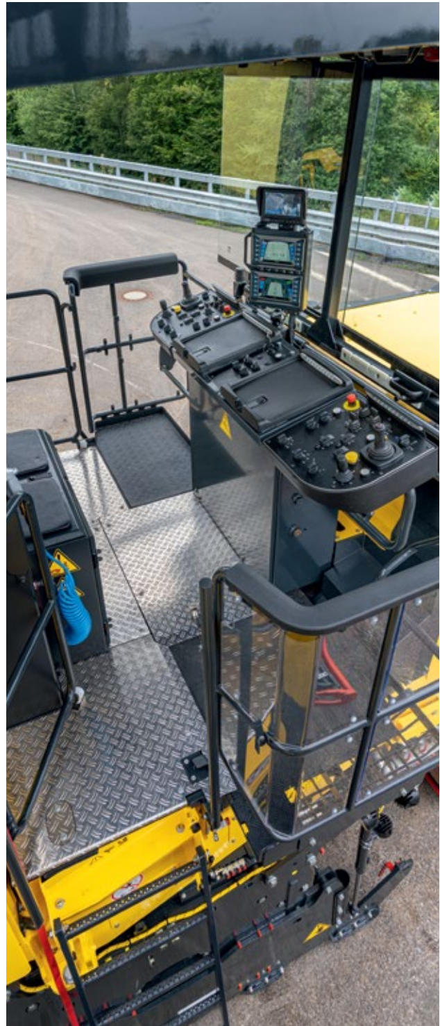
Desenvolvido para uma melhor visão geral e processos de trabalho intuitivos: o posto do operador na cabine com o painel de comando principal giratório.
